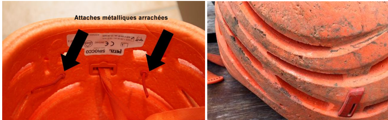
Sirocco : les deux attaches de l'élastique ont cédé. Traces d'utilisation intensive (superficielles).
