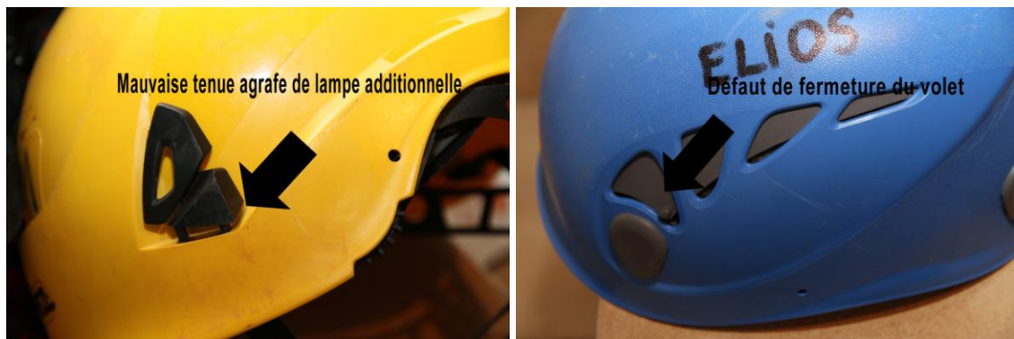
ALVEO et ELIOS, des accessoires qui prennent du jeu : fixations de frontale, volets d'aération.
